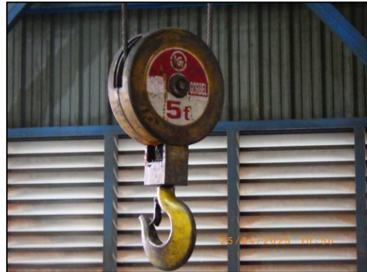
รูปที่ 2.35 ป้ายบอกพิกัดน้ำหนักยกไว้ที่ปั้นจั่นและระอกของตะขอ
