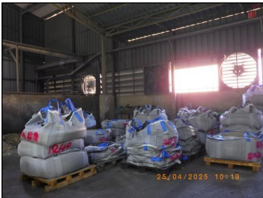
พื้นที่จัดเก็บตะกั่วจากกระบวนการหลอมโลหะ รวบรวมไว้ในถุง Big Bag ภายในพื้นที่อาคารดรอส
