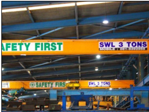
รูปที่ 2.35 ป้ายบอกพิกัดน้ำหนักยกไว้ที่ปั้นจั่นและระอกของตะขอ
